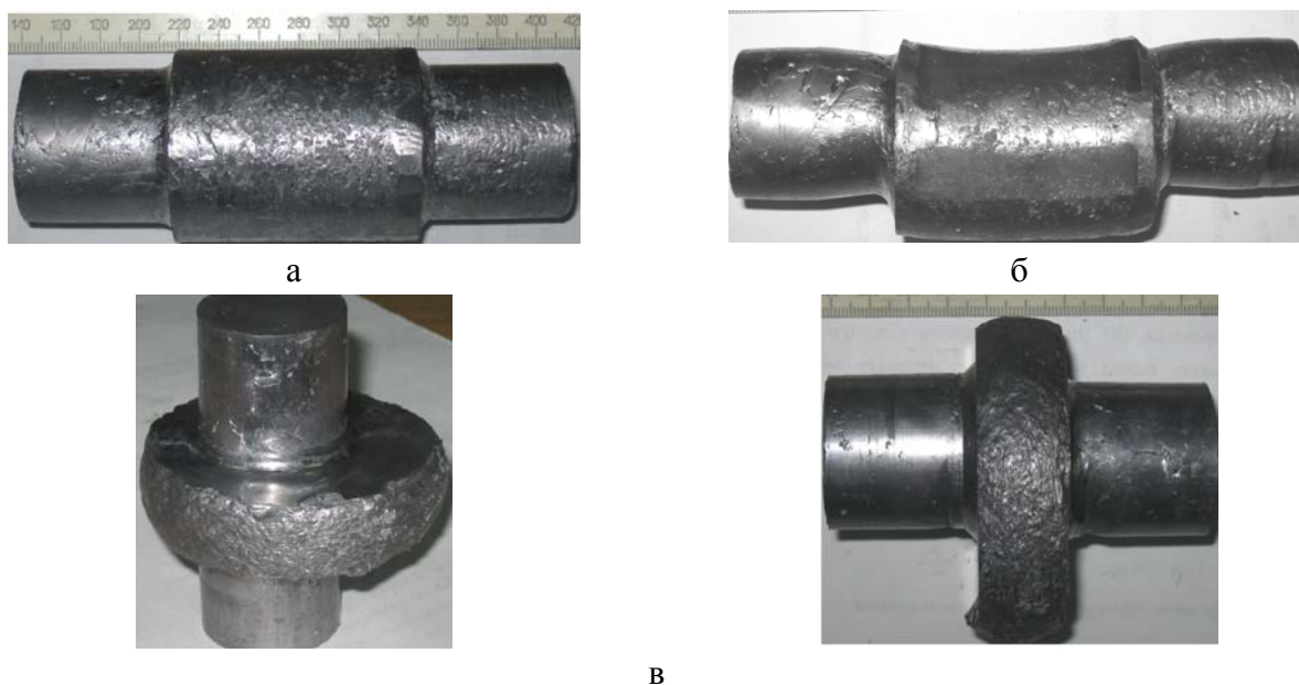
Рис. 9. Поэтапное деформирование заготовки при ковке эксцентрика: а – исходная заготовка; б – заготовка после смещения утолщения; в – полученный эксцентрик
